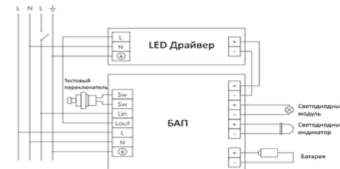
Рисунок 2. Электрическая схема подключения с БАП
