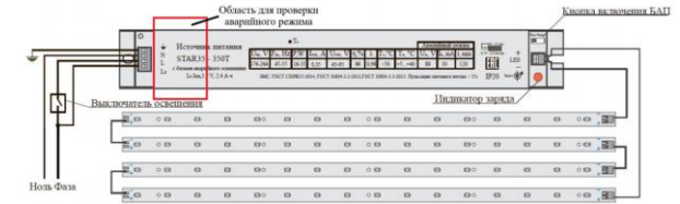
Рисунок 2. Электрическая схема подключения с БАП
