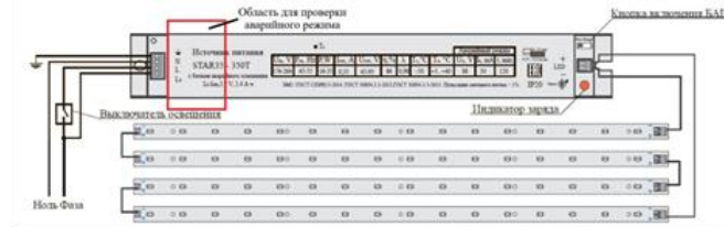
Рисунок 2. Электрическая схема подключения с БАП
